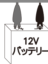
④外付けバッテリー用コード(別売)の赤線をバッテリー(別売)の+に、黒線を-に接続する
